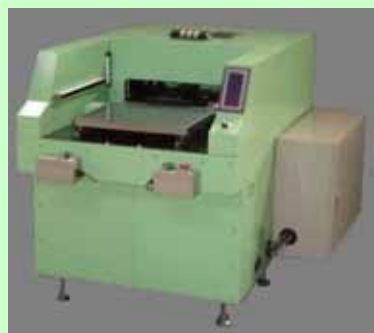
TJC-20 厚さ 5mm のゴム板を 打抜いています
