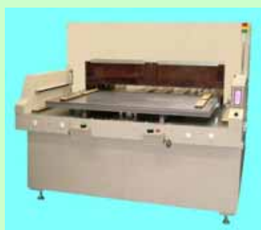
TJC-50 大きな樹脂プレート を打抜いています。
